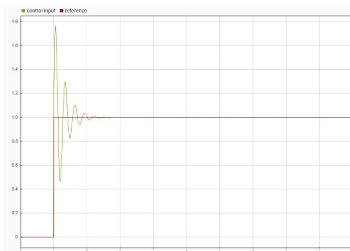
图 4.2.3 引入 P, I 时的输出曲线
