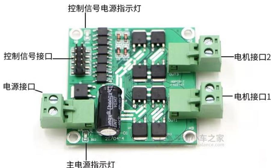
图 3.4.2 电机驱动的实物图与接口图
