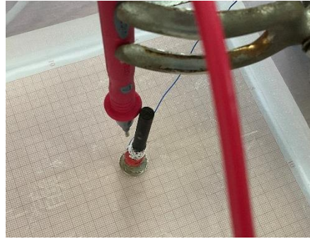
图 3: 石墨电极上产生的气泡
